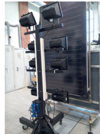
Abbildung 2: Industriell hergestellter Kollektor unbestrahlt
