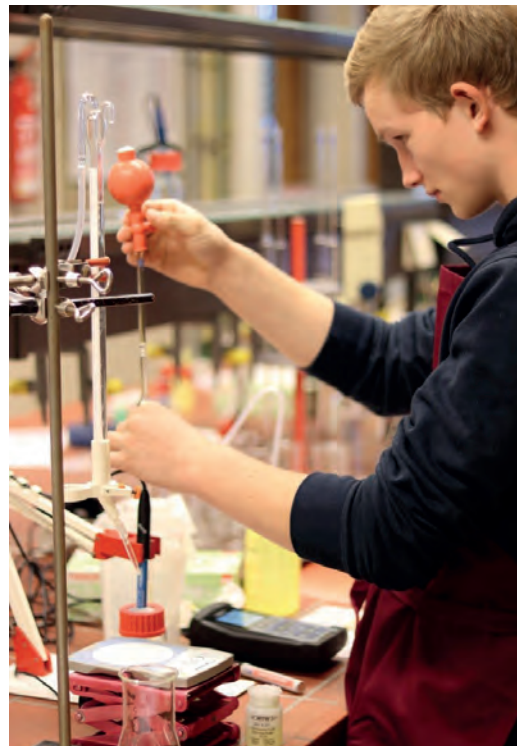
Abb. 2: Bestimmung des Säuregehaltes vom Apfelsaft durch Titration
