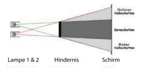
Eine punktförmige Lichtquelle ermöglicht scharfe Schattenränder. Mehrere Lichtquellen bilden Teilschatten, die sich zu dunkleren Kernschatten überlappen können.
