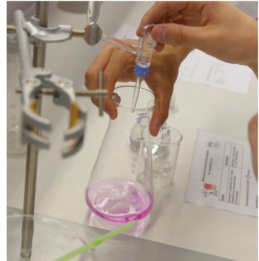
† Farbumschlag bei der Säure-Base-Titration mit Phenolphthalein als Indikator.
