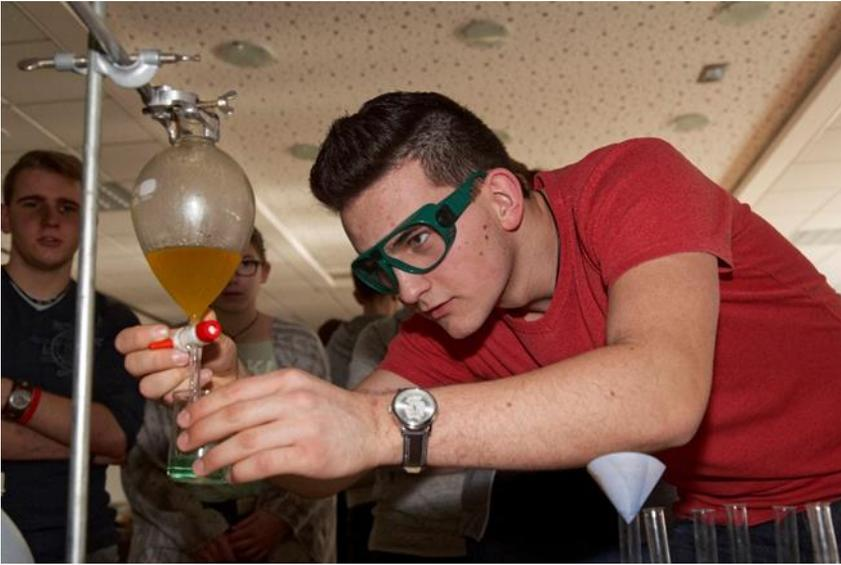
*Anionenaustauscher werden im Bergbau, wie auch im Recycling für schwierig zu trennende Stoffe, beispielsweise Seltene Erden, eingesetzt; im Workshop als Modellexperiment eines Gemisches kupfer-, und eisenhaltiger Chlorokomplexe.*
