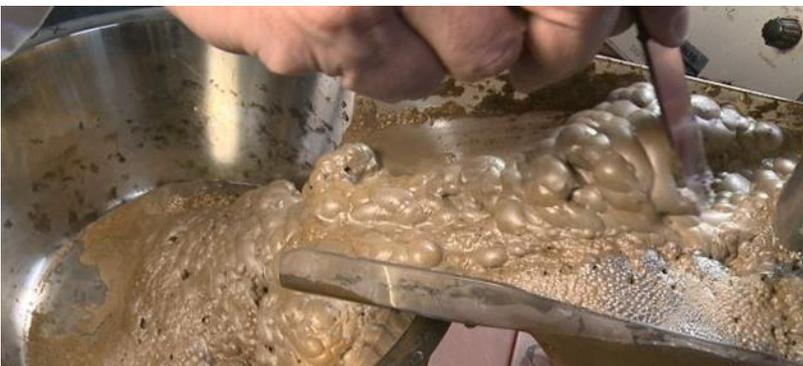
*Die Flotation als Trennmethode stammt aus dem Bergbau. Am Rammelsberg wurde sie im Gefolge der Autarkiebestrebungen des Dritten Reiches eingeführt; hier am Beispiel eines Bad Grundner Blei-Zinkerzes; in 90 Minuten im Workshop durchführbar.*
