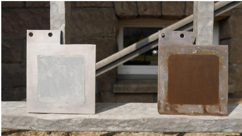
**Abbildung 5 Dachdeckerblei-Anode und Aluminium-Kathode nach der Elektrolyse**
