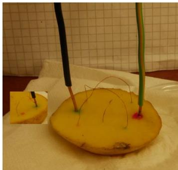
Abbildung 4 Nachweis des elektrischen Feldes durch chemische Reaktionen (Eigene Aufnahme).
